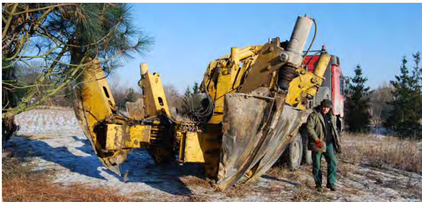
Maszyna przygotowana do wykopania drzewa
